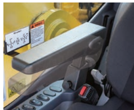
Armstütze mit einfacher Höhenverstellung
