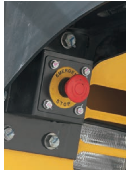
In der Kabine und um die Maschine herum befinden sich drei Motor-Not-Aus-Schalter, mit denen die Maschine serienmäßig ausgerüstet ist.
