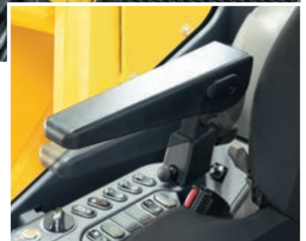
Armstütze mit einfacher Höhenverstellung
