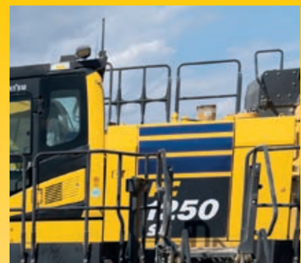
Handläufe und rutschfeste Oberflächen
