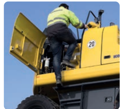
Handläufe und rutschfeste Oberflächen
