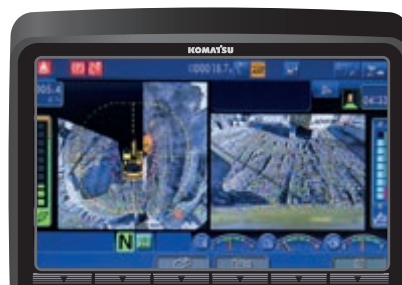
KomVision nutzt verschiedene Kameraansichten um eine permanente Sicht aus Vogelperspektive auf die Maschine zur Verfügung zu stellen
