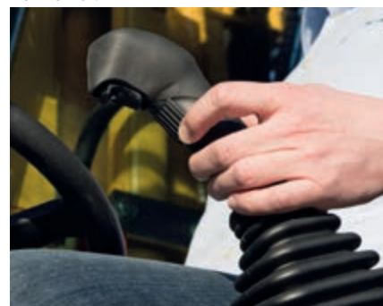
Das optional verfügbare und anpassbare Joystick-Lenksystem ermöglicht leichtgängiges Lenken der Maschine ohne großen Kraftaufwand
