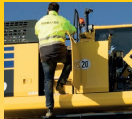
Gerade Leiter für Wartungszugang, Handläufe und rutschfeste Oberflächen
