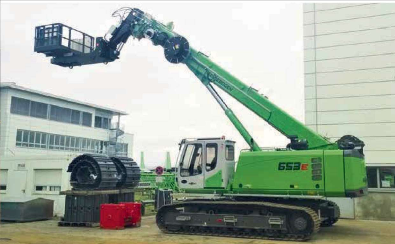
653 R - with aerial work platform, 4 m width max., availability on request, project-based 653 R - mit Hubarbeitsbühne, 4 m Breite max., Verfügbarkeit auf Anfrage, projektbasiert
