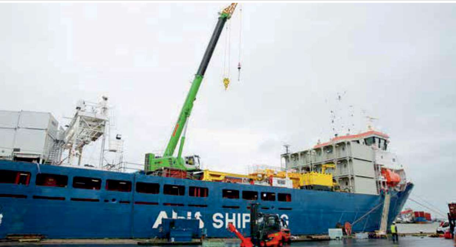
6113 R - used on ships as a service crane, even when on inclinations; Netherlands 6113 R - auf Schiffen als Servicekran auch bei Schrägstellung arbeiten; Niederlande
