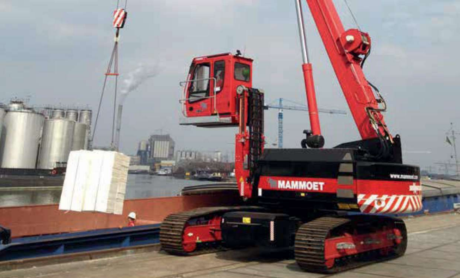
643 R - with elevating cab, also used during transshipment in the port; Netherlands 643 R - mit hochfahrbarer Kabine auch im Umschlag im Hafen; Niederlande
