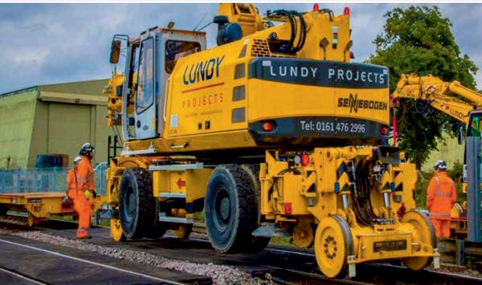
78 643 M - rail crane 643 M - Schienenkran
